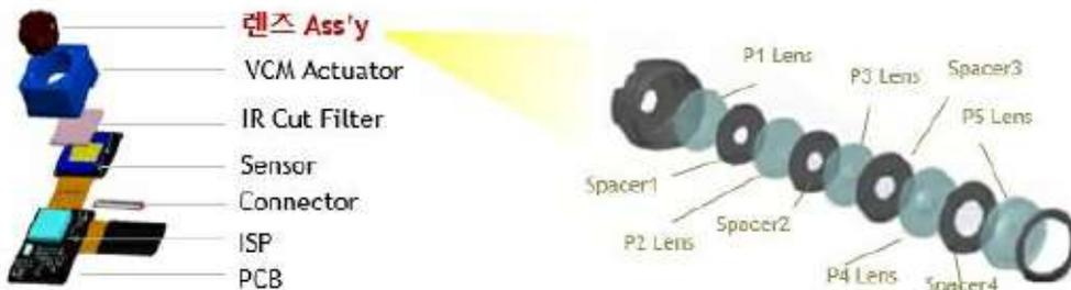
\* P Lens : 렌즈 당 4-6매 사용 / Spacer : 렌즈와 렌즈사이의 삽입물 / Barrel : 렌즈들이 적층되는 바디
